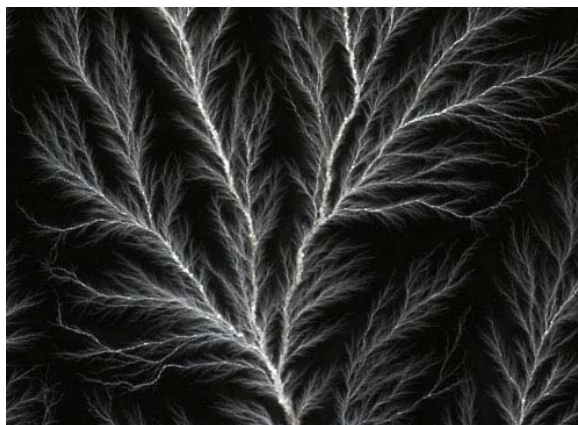
Figuur 16; Voorbeeld van electrical treeing (Data is Nature, 2009)
